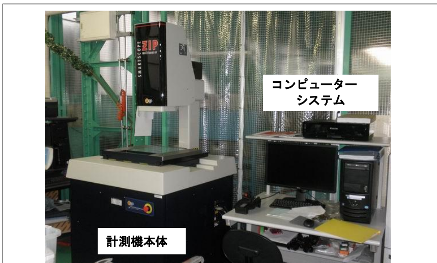
三次元計測システム装置の外観
